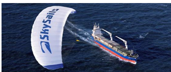
Figure 10 : Cargo tracté par un cerf-volant (image Skysails)
