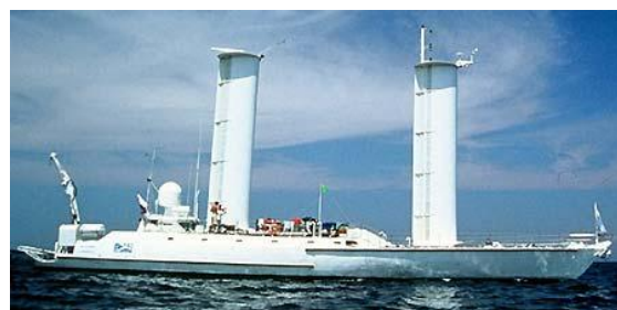
Figure 4: L'Alcyone du Commandant Cousteau avec ses profils aspirés de type Turbovoile
