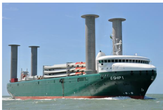
Figure 8: Le navire E-SHIP 1, équipé de quatre rotors Flettner
